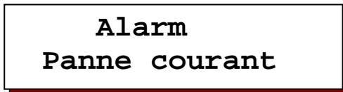
Le message "coupure secteur" apparaît lorsque la commande est remise en marche et la sortie d'alarme est programmée pour la situation de "coupure de courant".
