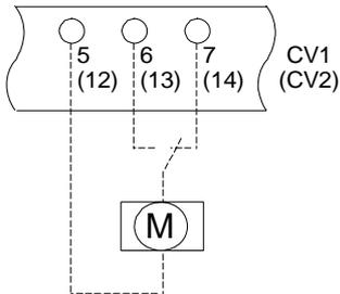
Vanne de commande centrale ou distributeur automatique sans position de fonctionnement automatique.
