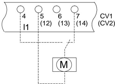
Vanne de commande centrale ou distributeur automatique sans position de fonctionnement automatique.
