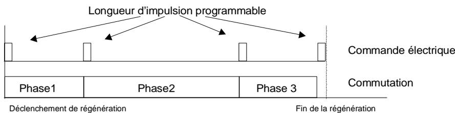
Exemple : Fonctionnement par impulsions à 4 phases
