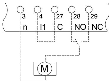
Raccordement de la vanne moteur à la sortie du relais libre de potentiel :
