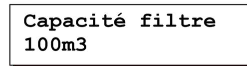
La quantité d'eau adoucie produite par un filtre entre deux régénérations est affichée. Avec les échangeur d'ions, les calculs sont effectués avec les valeurs actuelles programmées pour la capacité du filtre et la dureté de l'eau.
