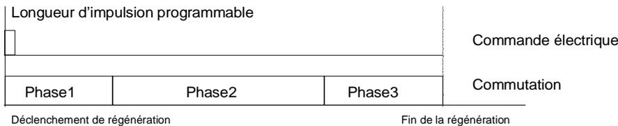
Le nombre des phases est sélectionné au stade 2.1 du programme, la durée de l'impulsion de commande au stade 3.1 et la durée des diverses phases de régénération au stade 4.1 du programme. ATTENTION ! La durée des diverses phases de régénération est prolongée de la durée de l'impulsion de commande.
