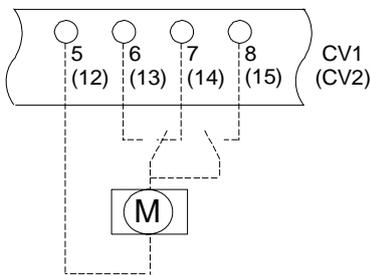
Vanne de commande centrale ou distributeur de pilotage avec position de fonctionnement automatique.
