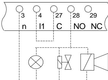
Raccordement d'un témoin lumineux, d'un klaxon ou d'une vanne magnétique activée à la sortie de relais libre de potentiel OUT1 ou OUT2.
