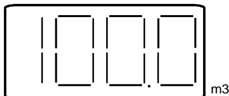
L'affichage LED indique la quantité d'eau qui doit être encore adoucie jusqu'à la régénération suivante.
