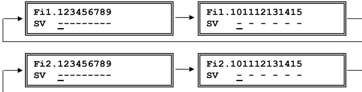
A ce stade du programme, vous programmez les vannes qui doivent être ouvertes à une phase déterminée. Il est possible de sélectionner l'étape d'activation en plaçant, à l'aide de la touche "▶", le curseur sous le numéro de l'étape d'activation. La touche "#" permet ensuite d'introduire le numéro de l'étape d'activation.
